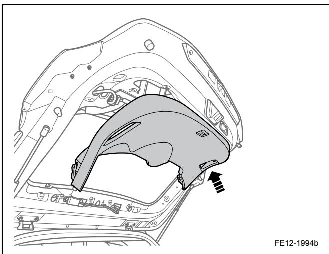
2. 将背门内饰板总成 11 颗卡扣对准其安装孔，按压饰板扣紧卡扣。 IT
