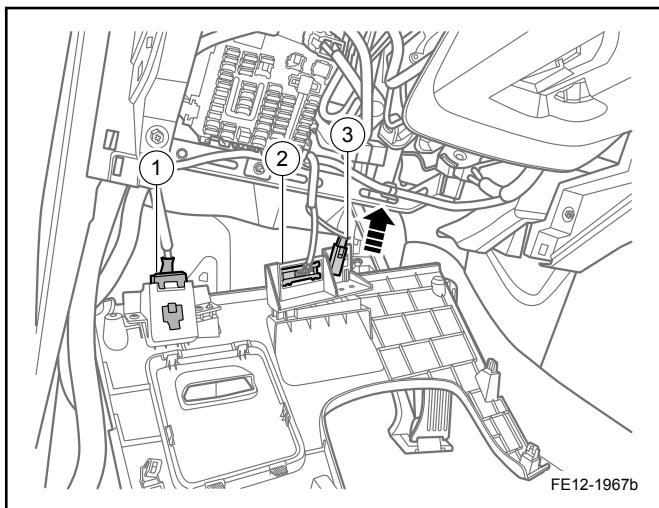
1. 安装仪表板左下护板, 安装发动机罩拉线并关 1 和诊断接口座 2, 连接脚部照明灯线束连接器插头 3。
