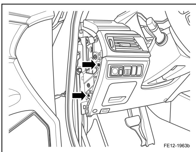
3. 拆卸仪表板左下护板左侧 2 颗固定螺钉。
