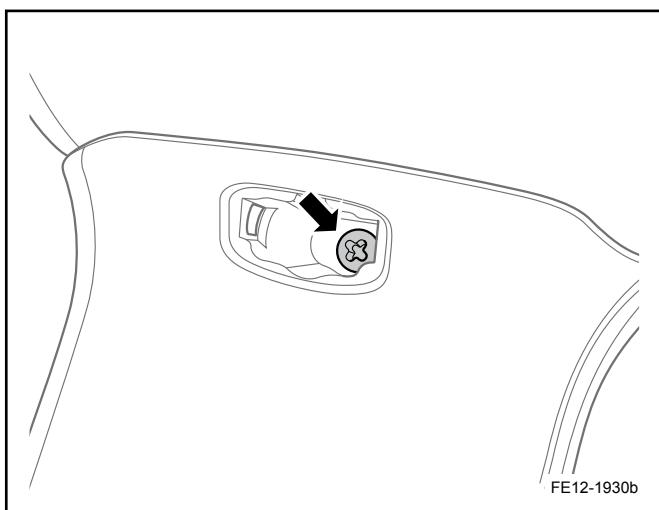
2. 安装中柱上装饰板上部固定螺栓。
