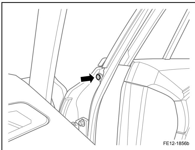
3. 安装右前车门密封条总成内侧的卡扣。
