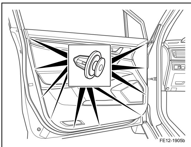
5. 拆卸左前车门内饰板上的 10 个 D 型卡扣，并分离左前门内饰板。
