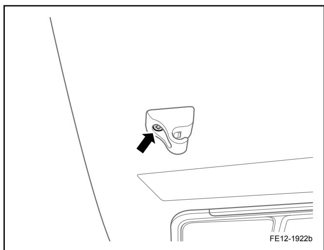
5. 拆卸左遮阳板挂钩固定螺栓，取出遮阳板挂钩。
