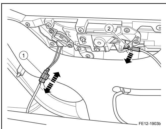
6. 断开左前车门高音扬声器线束连接器 1，拆卸左前车门内开启拉手拉线 2。
