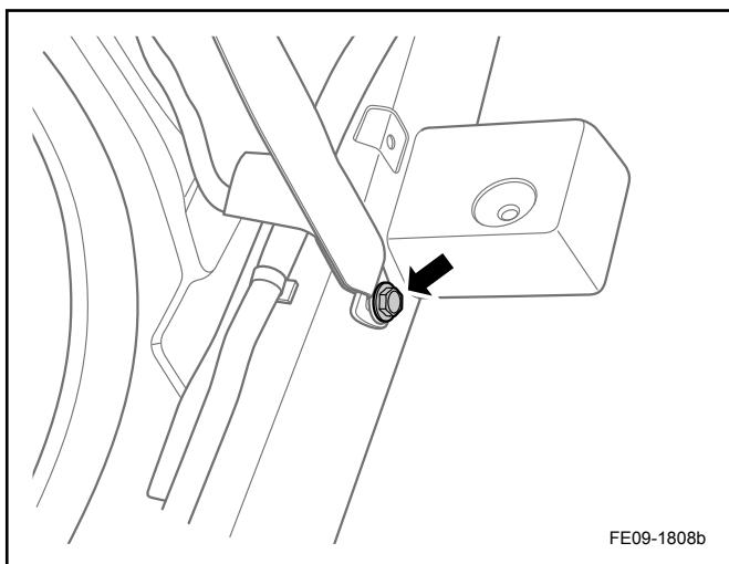
1. 安装中柱上装饰板和前排座椅安全带总成地板端固定螺栓。
