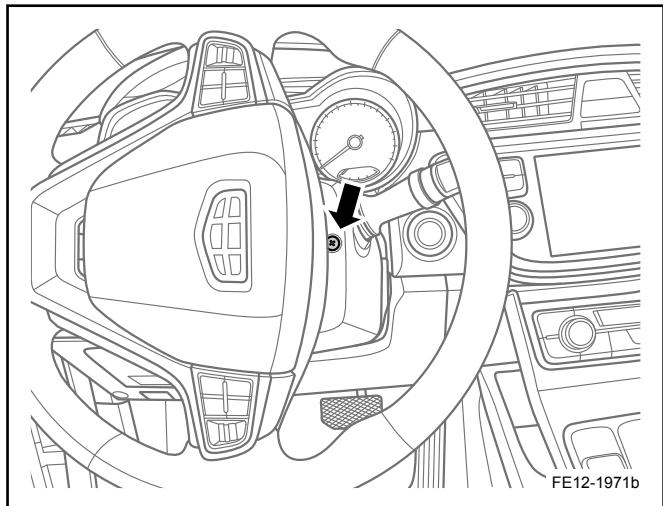
3. 拆卸转向管柱罩盖下方固定螺钉。
