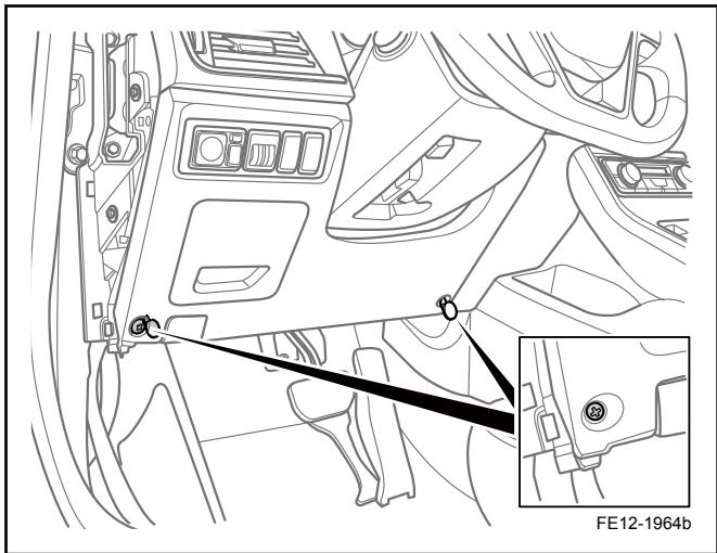
6. 断开仪表板左下护板开关组线束连接器插头。
