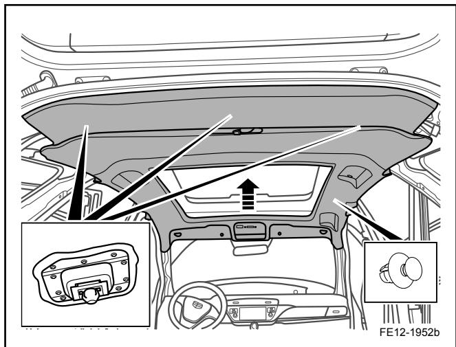
2. 安装顶盖内饰板总成后阅读灯支架 2 颗固定螺栓。
