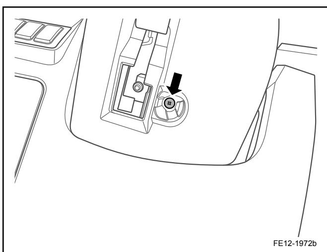
2. 安装转向管柱罩盖下方固定螺钉。
