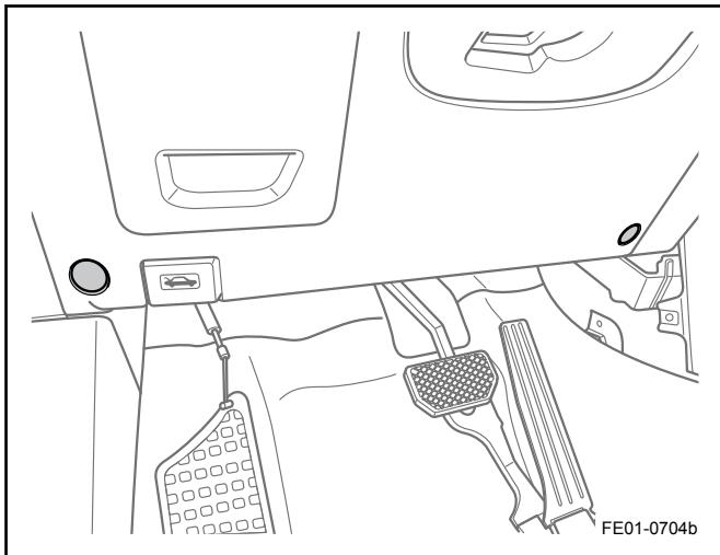
5. 安装仪表板左下护板左侧 2 颗固定螺钉。
