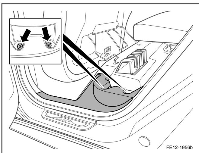
2. 拆卸后门门槛内饰板 2 颗固定螺栓。
