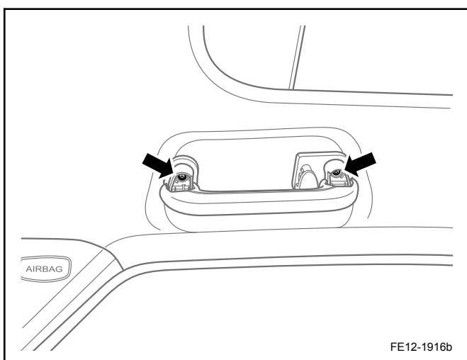
2. 拆卸安全拉手 2 颗固定螺栓。
