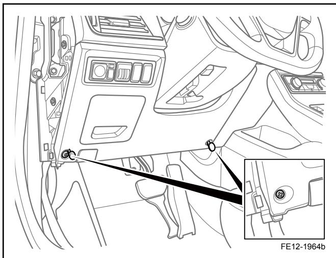
3. 安装仪表板左下护板并紧固下部 2 颗固定螺钉。
