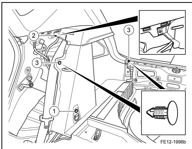
2. 安装行李舱右装饰板固定螺栓 1、固定螺钉 2 和 2 颗螺纹卡扣 3。
