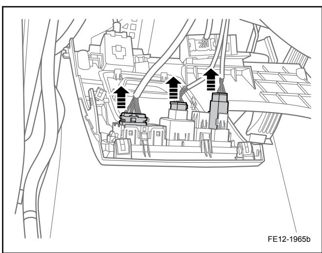
7. 拆卸发动机罩拉线并关 1 和诊断接口座 2，断开脚部照明灯线束连接器插头 3，取出仪表板左下护板。
