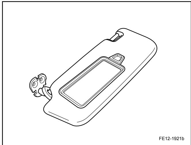
4. 拆卸固定螺栓后将遮阳板顺时针转动 90 度，然后再取下遮阳板。
