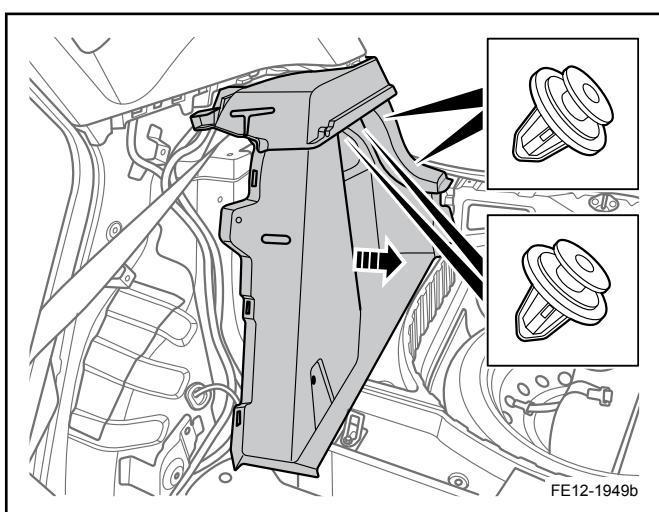
5. 用合适工具拆卸行李舱左装饰板 4 颗 D 型卡扣。
