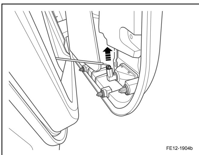
7. 拆卸左前车门内饰板门灯线束连接器，并取下左前车门内饰板。
