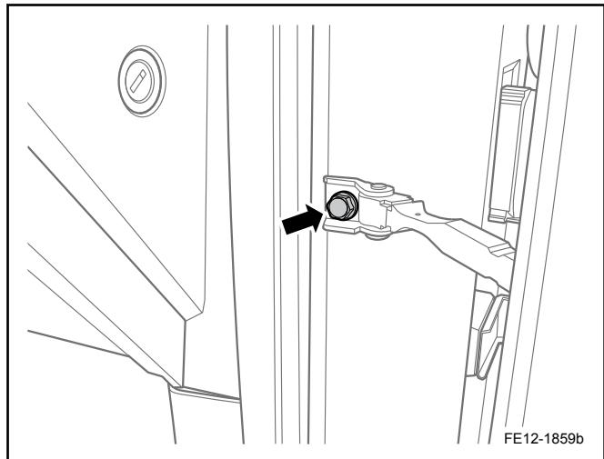
4. 拆卸右前门限位器上的固定螺栓并取下右前门密封条总成。
