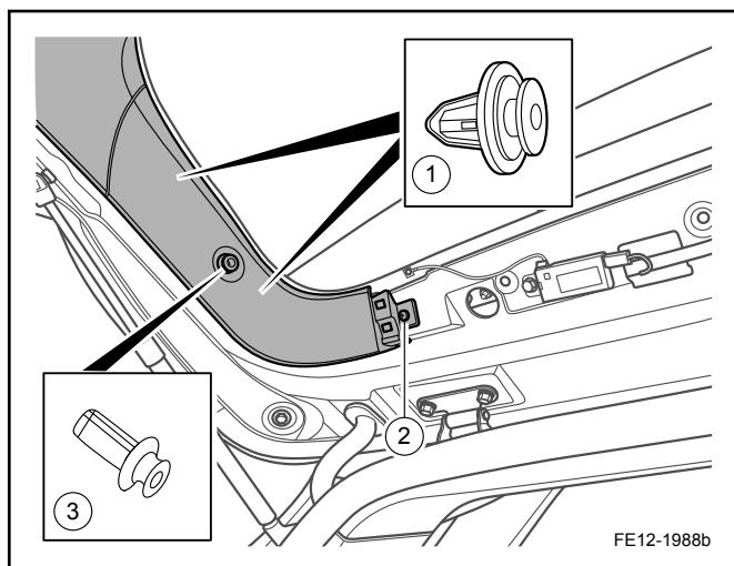
1. 安装背门上饰板，将背门上饰板总成 2 颗卡扣 1 对准其安装孔，按压饰板扣紧卡扣，同时将行李舱隔板装饰板挂钩 3 对准其安装孔，按压装饰板挂钩扣紧，并紧固固定螺钉 2.
