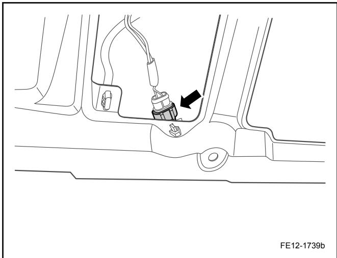
4. 拆卸后牌照灯安装板总成上的固定螺钉并取下后牌照灯安装板总成。
