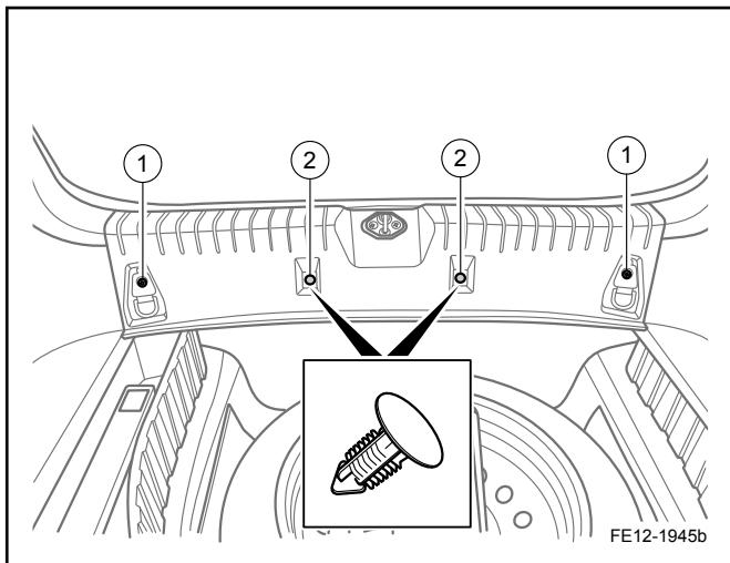
1. 打开背门拆卸后围内装饰板 2 颗固定螺栓 1 和 2 颗卡扣 2。
