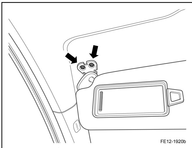
2. 安装遮阳板，并紧固 2 颗固定螺栓和扣紧遮阳板装饰盖。
