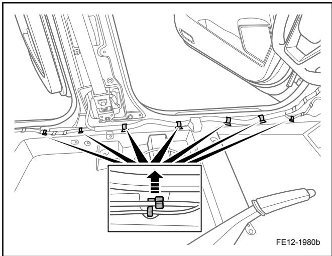
13. 用合适工具拆卸车内地毯后部卡扣。
