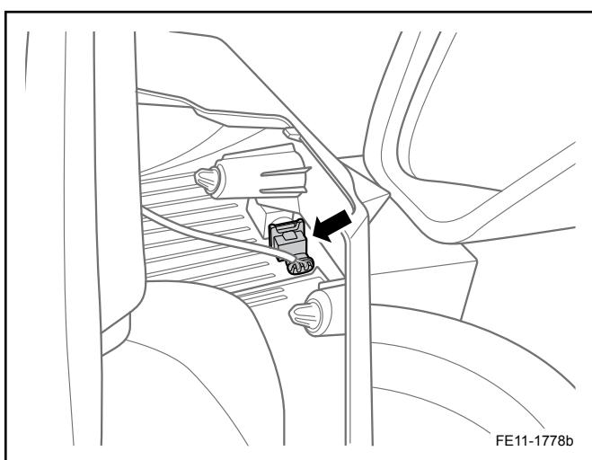
6. 断开行李舱照明灯线束连接器，取出行李舱左装饰板。
