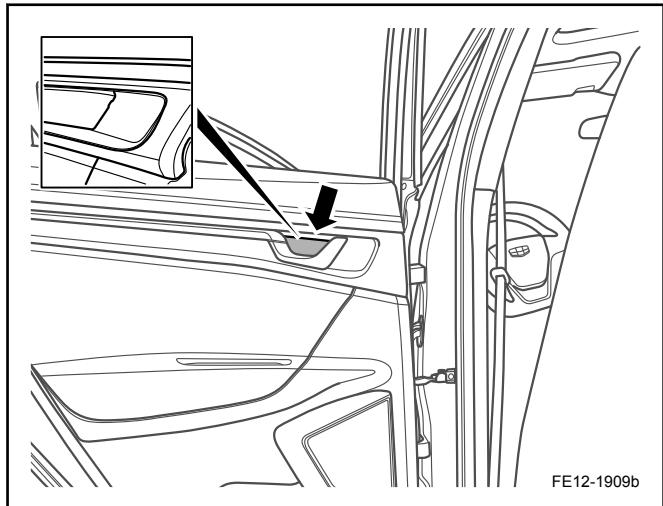
4. 拆卸左后车门内开启拉手侧固定螺钉。
