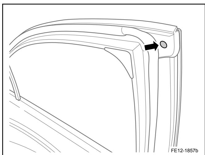
2. 安装右前车门密封条总成外侧上部的卡扣。
