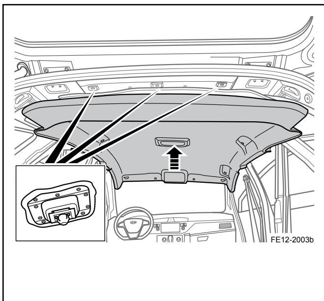
2. 安装顶盖内饰板总成后阅读灯支架 2 颗固定螺栓。
