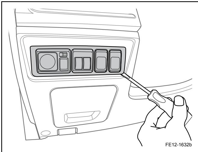
3. 断开室内行李箱开启开关线束连接器。
