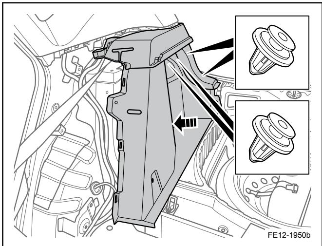
3. 安装行李舱左装饰板固定螺栓 1、固定螺钉 2 和 2 颗螺纹卡扣 3。
