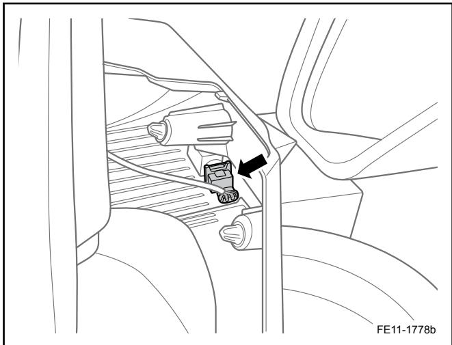
2. 将行李舱左装饰板 4 个卡扣对准其安装孔，按压饰板扣紧卡扣。
