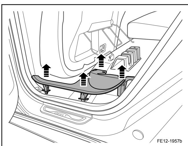
3. 用合适工具拆卸后门门槛内饰板。
