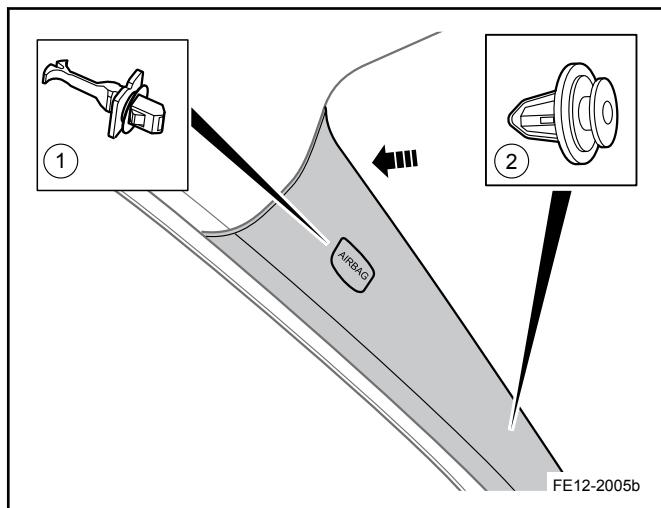
2. 将前柱上装饰板 2 个卡扣对准其安装孔，按压前柱上装饰板扣紧卡扣。
