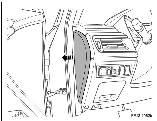
2. 用合适工具拆卸仪表板左侧装饰板。
