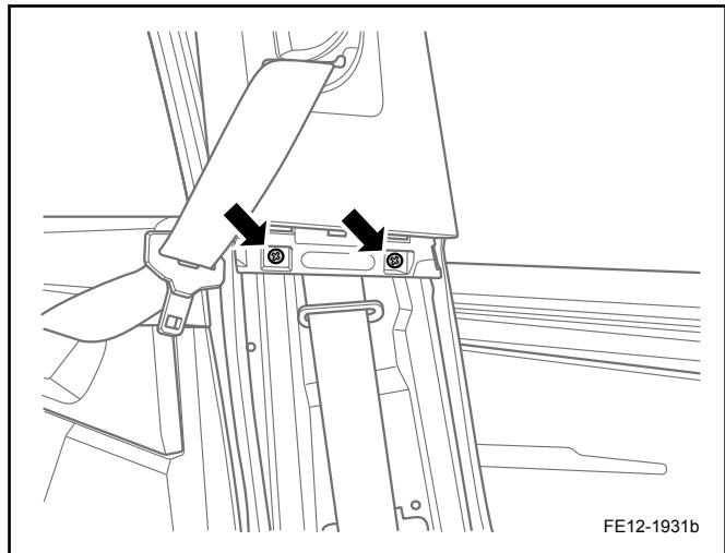
7. 拆卸中柱上装饰板下部 2 颗固定螺钉。
