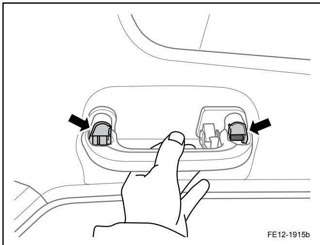
1. 拉住安全拉手拆卸安全拉手两端螺钉饰盖。
