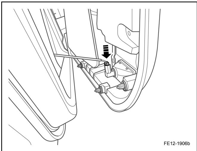
2. 连接左前车门高音扬声器线束连接器 1 和安装左前车门内开启拉手拉线 2。
