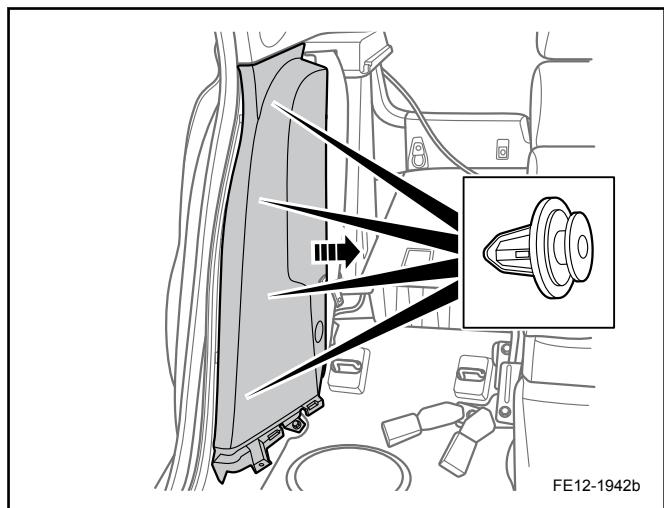
4. 用合适工具拆卸后柱下装饰板 4 颗 D 型卡扣。
