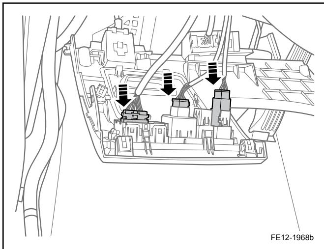
2. 连接仪表板左下护板开关组线束连接器插头。
