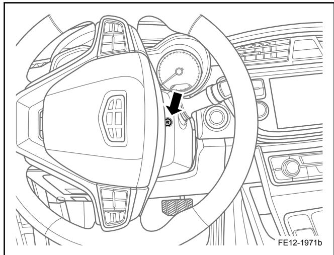
3. 调整方向盘至合适位置，并安装转向管柱罩盖右侧固定螺钉。
