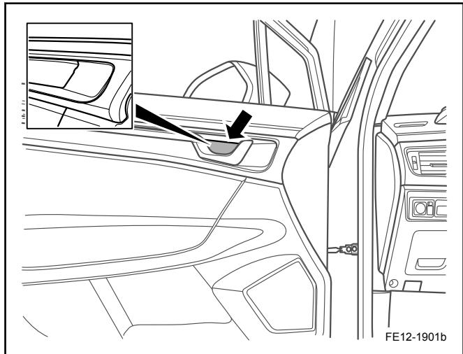
4. 拆卸左前车门内开启拉手侧固定螺钉。
