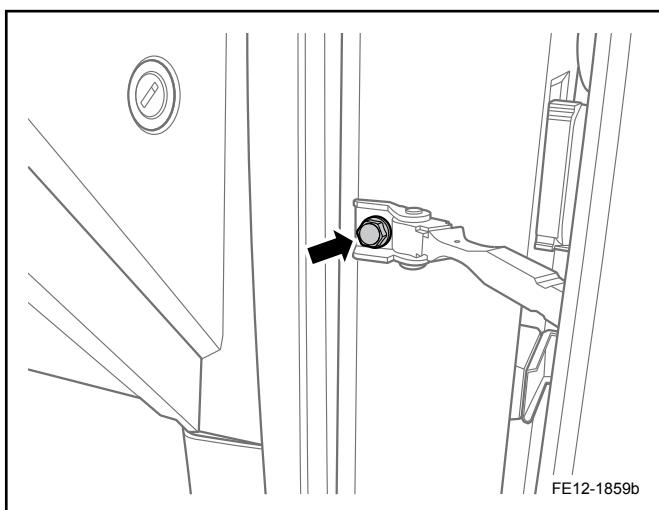
4. 安装并紧固车门限位器上的固定螺栓。
