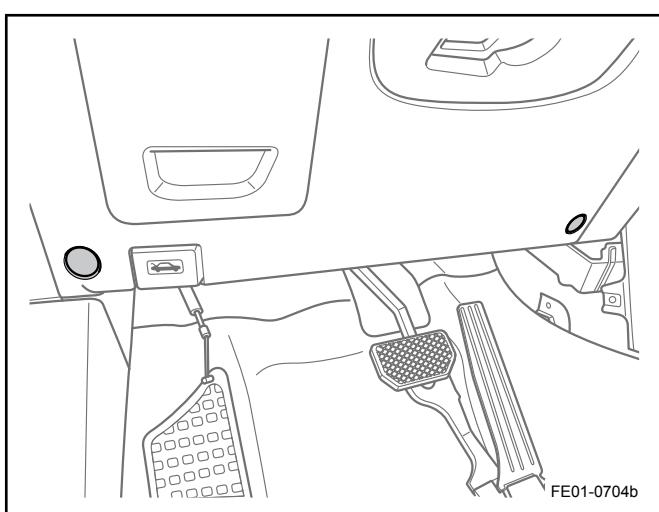
4. 拆卸仪表板左下护板上的堵盖。
