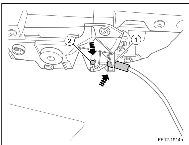
2. 拆卸固定左后车门内饰板的 9 颗 D 型卡扣，并分离左后车门内饰板。
