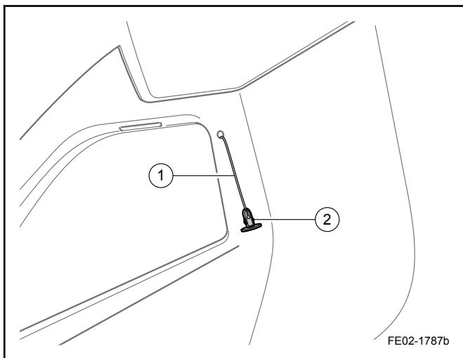
4. 安装油箱盖紧急开启把手 2 和紧急开启把手拉线 1。
