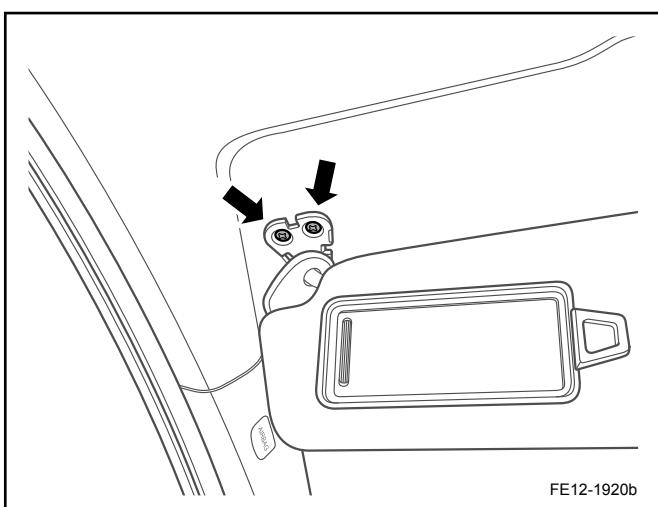
3. 拆卸遮阳板 2 颗固定螺栓。
