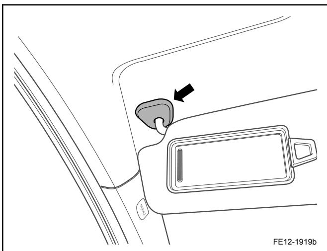
2. 用合适的工具拆卸遮阳板固定螺栓处的饰盖。
