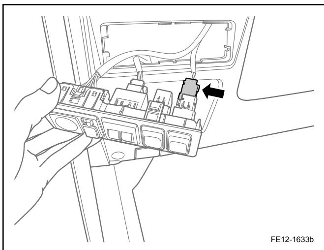
3. 安装室内行李箱开启开关安装板总成。
