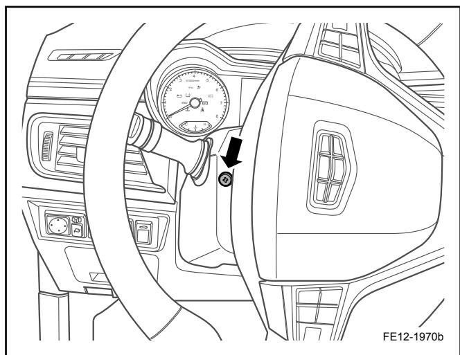
4. 调整方向盘至合适位置，并安装转向管柱罩盖左侧固定螺钉。
