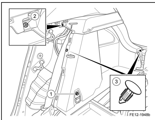
4. 拆卸行李舱左装饰板固定螺栓 1、固定螺钉 2 和 2 颗螺纹卡扣 3。
