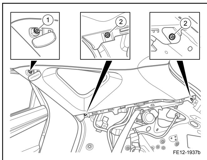
2. 安装并紧固后柱上装饰板固定螺栓 1 和 2 颗固定螺钉 2。
