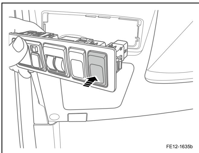
2. 连接室内行李箱开启开关线束连接器。
