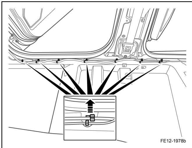
12. 用合适工具拆卸左侧车内地毯上部线束卡扣。
