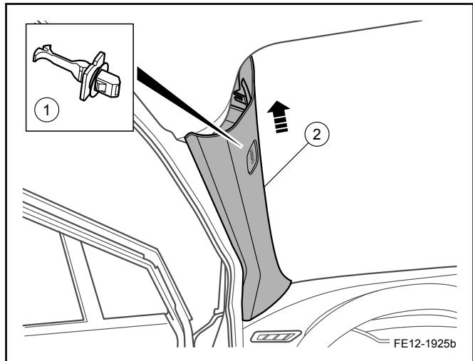
4. 用合适工具拆卸卡扣 1，向上抽出饰板 2。
