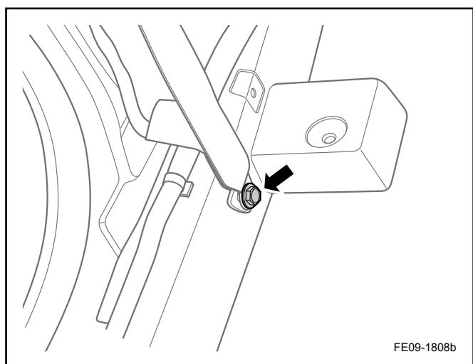
8. 拆卸前排座椅安全带总成地板端固定螺栓。
