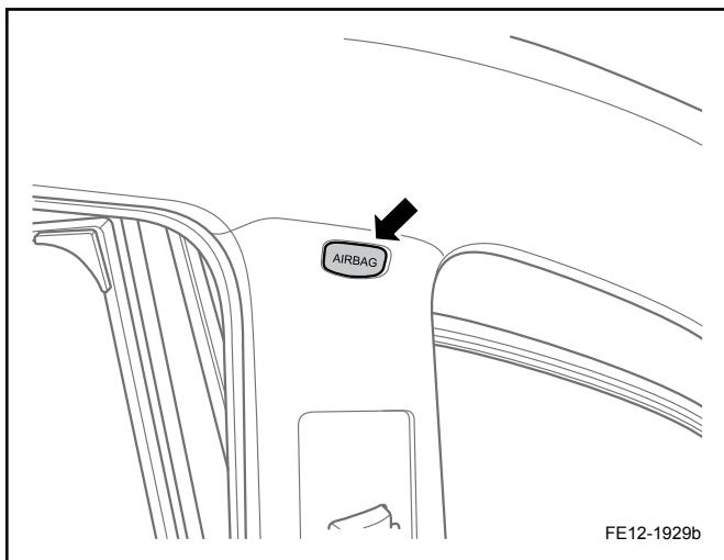
6. 拆卸中柱上装饰板上部固定螺栓。
