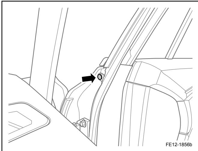
2. 拆卸右前车门密封条总成外侧上部的卡扣。
