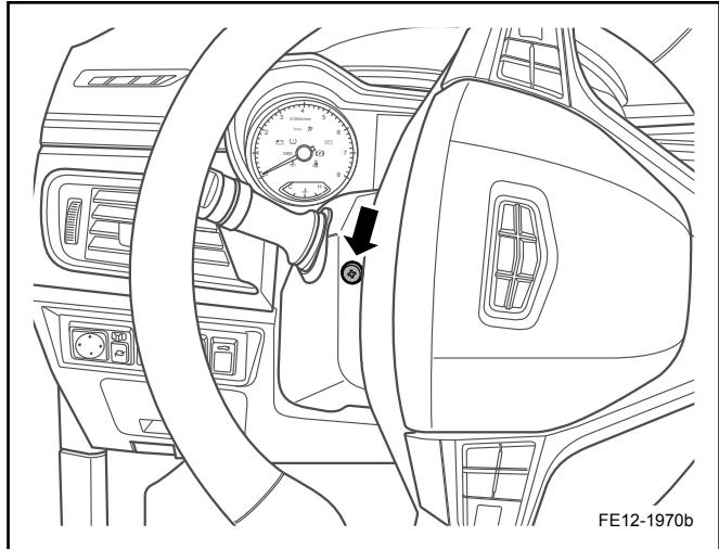
2. 调整方向盘至合适位置，并拆卸转向管柱罩盖右侧固定螺钉。
