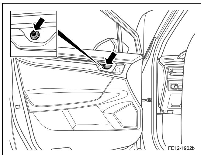
4. 安装左前车门内开启拉手侧固定螺钉。
